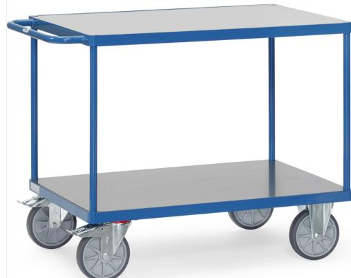
Stahlrohr und Profilstahl geschweißt, pulverbeschichtet RAL 5007. Mit zwei Plattformen mit Ladeflächen aus Hart-PVC. 2 Lenk- und 2 Bockrollen, TPE-Bereifung, Nabensicherung mit Rillenkugellager. Feststeller an den Lenkrollen. Tragkraft obere Ladefläche 200 kg.
