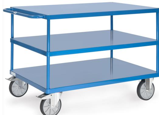
Stahlrohr und Profilstahl geschweißt, pulverbeschichtet RAL 5007. 3 Plattformen aus Stahlblech, bündig im Rahmen, sauber eingeschweißt, ebenfalls pulverbeschichtet RAL 5007. 2 Lenk- und 2 Bockrollen, TPE-Bereifung, Nabensicherung mit Rillenkugellager. Feststeller an den Lenkketten. Tragkraft obere und mittlere Ladefläche 200 kg.
