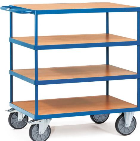
Stahlrohr und Profilstahl geschweißt, pulverbeschichtet RAL 5007. 4 Plattformen aus Holzwerkstoffplatte, Oberfläche Buchendekor. 2 Lenk- und 2 Bockrollen, TPE-Bereifung, Nabens mit Rillenkugellager. Feststeller an den Lenkrollen.
