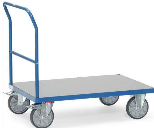
Schiebebügelwagen aus Stahlrohr und Profilstahl geschweißt, pulverbeschichtet brilliantblau RAL 5007. Plattform mit Ladefläche aus Hart-PVC-Platte. Hohe Chemikalienbeständigkeit und schwer entflammbar. 2 Lenk- und 2 Bockrollen, TPE-Bereifung, Nabensicherung mit Rillenkugellager. Feststeller an den Lenkrollen.
