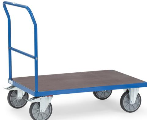
Schiebebügelwagen aus Stahlrohr und Profilstahl geschweißt, pulverbeschichtet brilliantblau RAL 5007. Plattform mit rutschsicherer Siebdruckplatte aus wasserfestem Sperrholz. 2 Lenk- und 2 Bockrollen, TPE-Bereifung, Nabensicherung mit Rillenkugellager. Feststeller an den Lenkketten.
