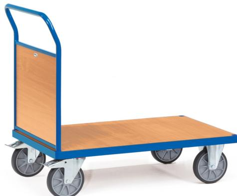
Stahlrohr und Profilstahl geschweißt, pulverbeschichtet blau RAL 5007, Plattform Holzwerkstoffplatte, Oberfläche Buchendekor. Stirnwand aus Holzwerkstoffplatte, Oberfläche Buchendekor, Wand 500 mm hoch. 2 Lenk- und 2 Bockrollen, TPE-Bereifung, Nabensicherung mit Rillenkugellager. Feststeller an den Lenkrollen.
