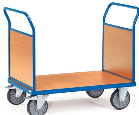
Stahlrohr und Profilstahl geschweißt, pulverbeschichtet blau RAL 5007, Plattform Holzwerkstoffplatte, Oberfläche Buchendekor. 2 Stirnwände aus Holzwerkstoffplatte, Oberfläche Buchendekor, Wände 500 mm hoch. 2 Lenk- und 2 Bockrollen, TPE-Bereifung, Nabenhügel mit Rillenkugellager. Feststeller an den Lenkketten.
