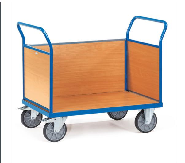
Stahlrohr und Profilstahl geschweißt, pulverbeschichtet blau RAL 5007, Plattform Holzwerkstoffplatte, Oberfläche Buchendekor. 2 Stirnwände und 1 Längswand aus Holzwerkstoffplatte, Oberfläche Buchendekor, Wände 500 mm hoch. 2 Lenk- und 2 Bockrollen, TPE-Bereifung, Naben mit Rillenkugellager. Feststeller an den Lenkrollen.
