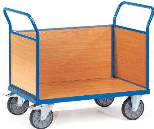
Stahlrohr und Profilstahl geschweißt, pulverbeschichtet blau RAL 5007, Plattform Holzwerkstoffplatte, Oberfläche Buchendekor. 2 Stirnwände und 1 Längswand aus Holzwerkstoffplatte, Oberfläche Buchendekor, Wände 500 mm hoch. 2 Lenk- und 2 Bockrollen, TPE-Bereifung, Nabenhügel mit Rillenkugellager. Feststeller an den Lenkrollen.
