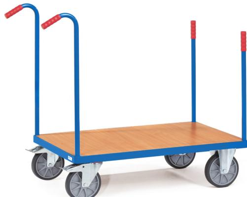
Stahlrohr und Profilstahl geschweißt, pulverbeschichtet RAL 5007, Plattform Holzwerkstoffplatte, Oberfläche Buchendekor. 2 Lenk- und 2 Bockrollen, TPE-Bereifung, Nabens mit Rillenkugellager. Feststeller an den Lenkrollen.
