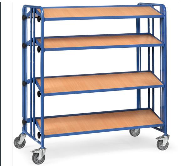
Baukasten-System: Stahlrohr- und Profilstahlgeschweißt, pulverbeschichtet blau RAL 5007, Schraubkonstruktion. 4 zweiteilige Etagen mit Holzwerkstoffplatten, Oberfläche Buchendekor, Rand 12 mm hoch. Variabel einschraubbare Etagen. Einschraubraster 100 mm, Neigung stufenlos einstellbar von 0° bis 35°, sichere Arretierung mittels Griffsschrauben. Deutsches Patent: 10 2005 062 391. Tragkraft pro Ladefläche 60 kg. 4 Lenkketten, TPE-Bereifung, Nabensicherung. 2 Stück mit Feststeller.
