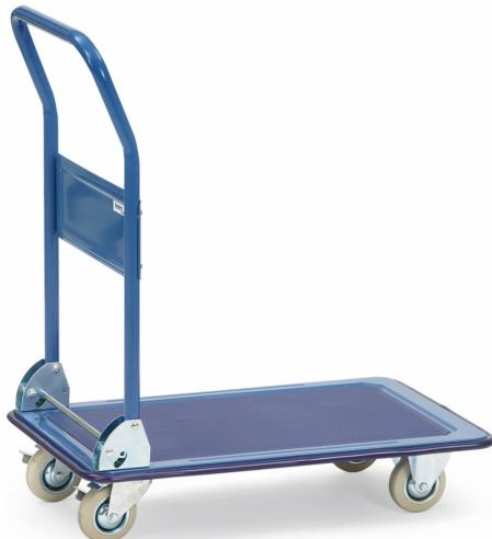
Ganzstahlwagen mit Plattform aus Stahlblech gepresst, pulverbeschichtet blau RAL 5007. Mit aufgeklebtem Antirutschbelag und umlaufender Schutzleiste. Rohrschiebebügel klappbar, mit breiter Querstrebe. Klappgelenk glanzverzinkt. 2 Lenk- und 2 Bockrollen, Vollgummibereifung, Feststeller an den Lenkrollen. Zerlegte Anlieferung.
