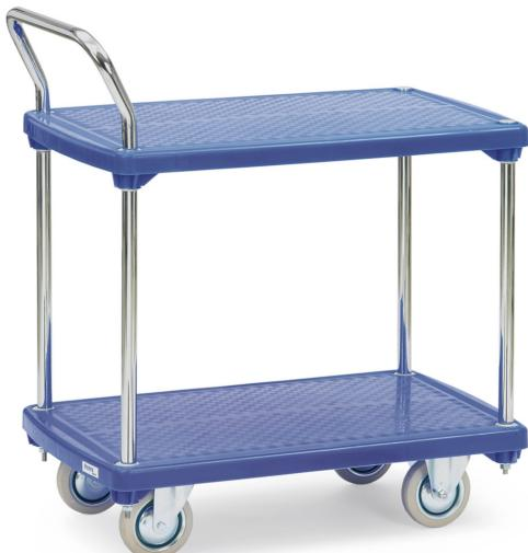
Tischwagen mit 2 Etagen. Plattformen aus Kunststoff gespritzt mit rutschhemmender Oberfläche (Farbe blau). Rohrschiebebügel feststehend, glanzverzinkt. 2 Lenk- und 2 Bockrollen, Vollgummibereifung blaugrau spurlos. Feststeller an den Lenkrollen. Tragkraft obere Ladefläche 80 kg. Zerlegte Anlieferung.
