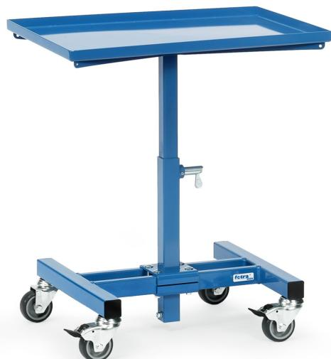
Für Kunststoffkästen, Stahlblechkästen, Drahtkörbe usw., höhenverstellbar und fahrbar. Profilstahl-/Rohrkonstruktion mit Stahlblechplattform mit allseitigem Rand 20 mm hoch. Nicht neigbar. Höhenverstellbar im Raster von 25 mm. Pulverbeschichtet brilliantblau RAL 5007. 4 Lenkketten mit TPE-Bereifung, Nabensicherung. Feststeller an 2 Lenkketten.
