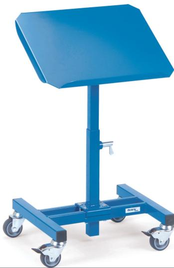
Für Kunststoffkästen, Stahlblechkästen, Drahtkörbe usw., höhenverstellbar und fahrbar. Profilstahl-/Rohrkonstruktion mit Stahlblechplattform mit einseitiger Anlagekante, neigbar um 15° und 30°. Höhenverstellbar im Raster von 25 mm. Pulverbeschichtet brillantblau RAL 5007. 4 Lenkrollen mit TPE-Bereifung, Naben mit Gleitlagerung. Feststeller an 2 Lenkrollen.
