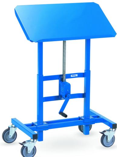
Für Kunststoffkästen, Stahlblechkästen, Drahtkörbe usw., höhenverstellbar und fahrbar. Profilstahl-/Rohrkonstruktion mit Stahlblechplattform. Plattform mit einseitiger Anlagekante, neigbar um 15° und 30°, stufenlos höhenverstellbar mittels Zahnstangenwinde, auch unter Last möglich. 2 Teleskopsäulen. Pulverbeschichtet blau RAL 5007. 4 Lenkrollen, Naben mit Gleitlagerung, 2 davon mit Feststeller.
