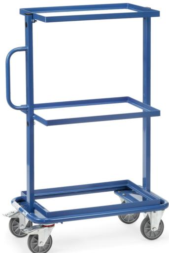
Beistellwagen aus Stahlrohr- und Profilstahl-Konstruktion, pulverbeschichtet, blau RAL 5007. Mit 3 offenen Rahmen passend für Eurokästen. 2 Lenk- und 2 Bockrollen, TPE-Bereifung, Nabens mit Rillenkugellager. Feststeller an den Lenkketten. Tragkraft obere und mittlere Ladefläche 50 kg.
