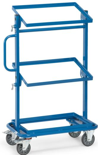
Beistellwagen aus Stahlrohr- und Profilstahl-Konstruktion, pulverbeschichtet, blau RAL 5007. Mit 3 offenen Rahmen passend für Eurokästen. Obere und mittlere Etagen nach beiden Seiten um 15° und 30° neigbar. Arretierung mittels Federriegel. 2 Lenk- und 2 Bockrollen, TPE-Bereifung, Nabenhügel mit Rillenkugellager. Feststeller an den Lenkrollen. Tragkraft obere und mittlere Ladefläche 50 kg.
