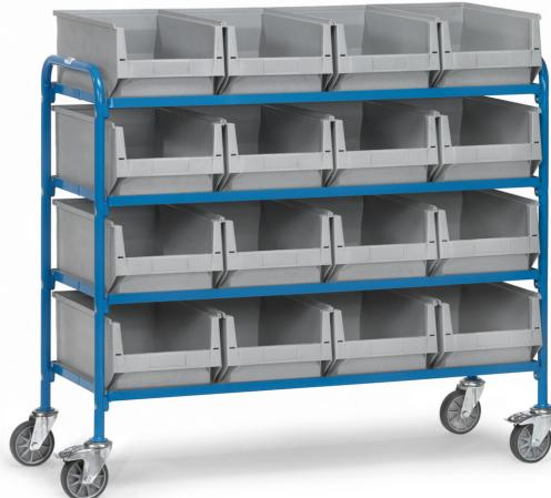
Baukasten-System: Stahlrohr- und Profilstahl geschweißt, pulverbeschichtet blau RAL 5007, Schraubkonstruktion. 4 Etagen mit Holzwerkstoffplatten, Rand 10 mm hoch und 16 Sichtlagerkästen (LxBxH: 500/450 x 310 x 200 mm). Tragkraft pro Ladefläche 60 kg. 4 Lenkketten, TPE-Bereifung, Nabensicherung. 2 Stück mit Feststeller.
