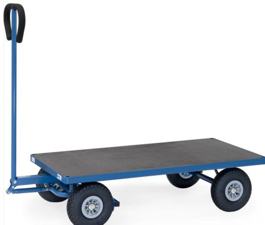
Aus Profilstahl und Stahlrohr geschweißt, pulverbeschichtet blau RAL 5007. Ladefläche aus wasserfestem Sperrholz. Drehschemel-Lenkung mit Deichsel und Handgriff. Räder mit Luftbereifung, Nabens mit Rollenlager. Deichsel mit Sicherheitshandgriff mit Softgripbezug und automatischer gedämpfter Rückstellung in Ruheposition. Automatische Feststellbremse auf die Vorderräder wirkend.
