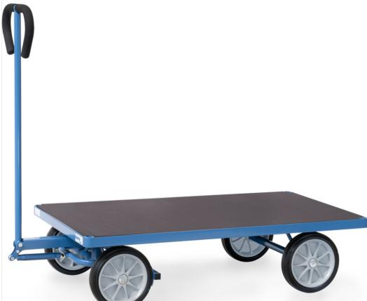
Aus Profilstahl und Stahlrohr geschweißt, pulverbeschichtet blau RAL 5007. Ladefläche aus wasserfestem Sperrholz. Drehschemel-Lenkung mit Deichsel und Handgriff. Räder mit Vollgummibereifung, Nabens mit Rollenlager. Deichsel mit Sicherheitshandgriff mit Softgripbezug und automatischer gedämpfter Rückstellung in Ruheposition. Automatische Feststellbremse auf die Vorderräder wirkend.
