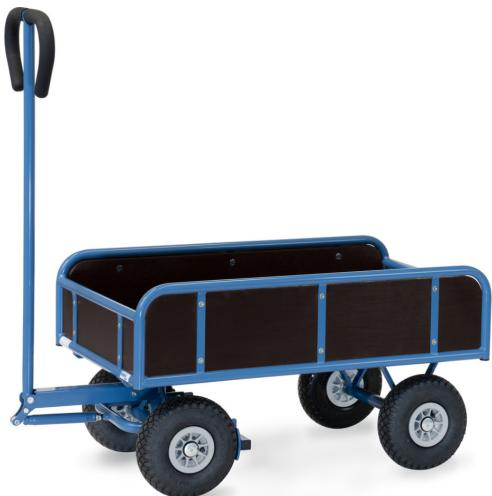
Aus Stahlrohr geschweißt, pulverbeschichtet brilliantblau RAL 5007. Geländer 180/250 mm hoch, Ladefläche und Wände aus wasserfestem Sperrholz. Drehschemel-Lenkung mit Deichsel und Handgriff. Deichsel mit Sicherheitshandgriff mit Softgrip-Bezug und automatischer gedämpfter Rückstellung in Ruheposition. Räder mit Luftbereifung, Naben mit Rollenlager. Automatische Feststellbremse auf die Vorderräder wirkend.
