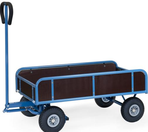
Aus Stahlrohr geschweißt, pulverbeschichtet brilliantblau RAL 5007. Geländer 180/250 mm hoch, Ladefläche und Wände aus wasserfestem Sperrholz. Drehschemel-Lenkung mit Deichsel und Handgriff. Deichsel mit Sicherheitshandgriff mit Softgrip-Bezug und automatischer gedämpfter Rückstellung in Ruheposition. Räder mit Luftbereifung, Naben mit Rollenlager. Automatische Feststellbremse auf die Vorderräder wirkend.
