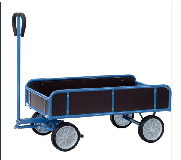
Aus Stahlrohr geschweißt, pulverbeschichtet brilliantblau RAL 5007. Geländer 180/250 mm hoch, Ladefläche und Wände aus wasserfestem Sperrholz. Drehschemel-Lenkung mit Deichsel und Handgriff. Deichsel mit Sicherheitshandgriff mit Softgrip-Bezug und automatischer gedämpfter Rückstellung in Ruheposition. Räder mit Vollgummibereifung, Nabens mit Rollenlager. Automatische Feststellbremse auf die Vorderräder wirkend.
