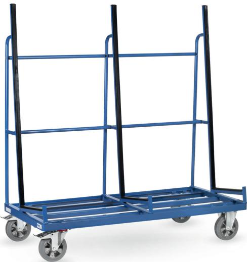
Baukasten-System: zum sicheren Transport von Glasscheiben, Holz- und Kunststoffplatten sowie kompletter Fenster und Türen. Profilstahl und Stahlrohr geschweißt. Pulverbeschichtet, blau RAL 5007. Einseitige Anlagen mit Profilgummi belegt. Auflagebreite 430 mm, Anlagehöhe 1450 mm. 2 Lenk- und 2 Bockrollen, Vollgummi-Elastic-Bereifung, blaugrau "spurlos", Naben mit Kugellager. Feststeller an den Lenkrollen.
