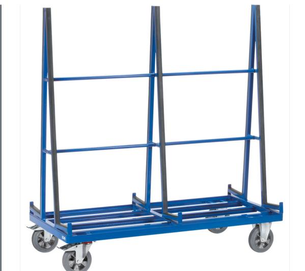
Baukasten-System: zum sicheren Transport von Glasscheiben, Holz- und Kunststoffplatten sowie kompletter Fenster und Türen. Profilstahl und Stahlrohr geschweißt. Pulverbeschichtet, blau RAL 5007. Zweiseitige Anlagen mit Profilgummi belegt. Auflagebreite 2 x 230 mm, Anlagehöhe 1450 mm. 2 Lenk- und 2 Bockrollen, Vollgummi-Elastic-Bereifung, blaugrau "spurlos", Naben mit Kugellager. Feststeller an den Lenkrollen.
