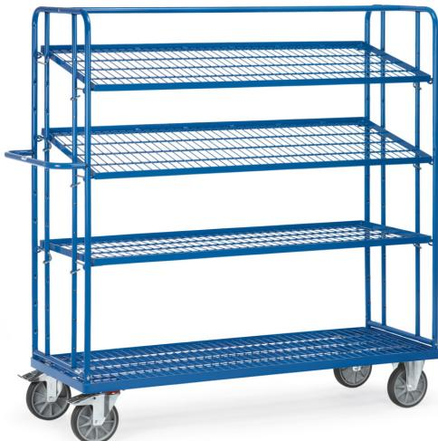
Stahlrohr-/Profilstahl-Konstruktion, pulverbeschichtet RAL 5007. 1 fester und 3 lose Böden mit eingeschweißtem Drahtgitter, 140 x 40 mm pulverbeschichtet. Lose Böden mit 15 mm hohem Rand an den Längsseiten, variabel einhängbar Raster 120 mm. Mögliche Neigung bei schräger Einhängung ca. 15 und ca. 30 Grad. Tragkraft pro Einlegeboden 50 kg. 2 Lenk- und 2 Bockrollen, TPE-Bereifung, Nabens mit Rillenkugellager. Feststeller an den Lenkrollen.
