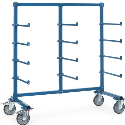
Rahmen aus stabilem Quadratrohr. Rollen-Traversen, Pfosten und Streben durch kräftige Schraubschellen verbunden. Tragarme aus Stahlrohr 27 mm Ø mit Schraubschellen. 12 Tragarmrohre mit PVC-Schlauch 3 mm stark überzogen, als Abrutschschutz und zur Schonung des Ladegutes und mit Abrollsicherung. Nutzlänge 600 mm, Tragkraft pro Etage 80 kg. Pulverbeschichtet blau RAL 5007. 2 Lenk- und 2 Bockrollen, TPE-Bereifung, Naben mit Rillenkugellager. Feststeller an den Lenkrollen.
