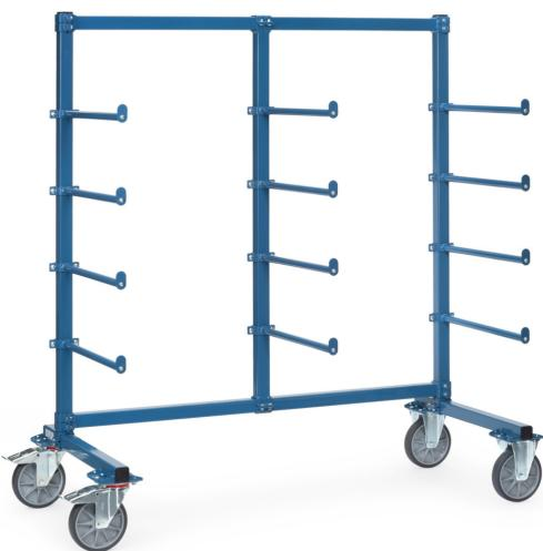
Rahmen aus stabilem Quadratrohr. Rollen-Traversen, Pfosten und Streben durch kräftige Schraubschellen verbunden. Tragarme aus Stahlrohr 27 mm Ø mit Schraubschellen. 12 Tragarme einseitig mit Abrollsicherung. Nutzlänge 600 mm, Tragkraft pro Etage 80 kg. Pulverbeschichtet blau RAL 5007. 2 Lenk- und 2 Bockrollen, TPE-Bereifung, Nabensicherung mit Rillenkugellager. Feststeller an den Lenkrollen.
