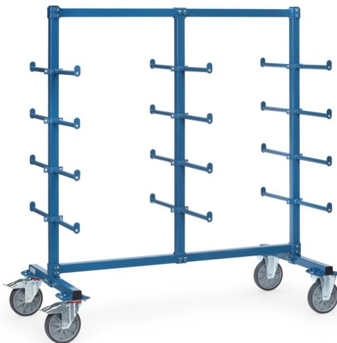
Rahmen aus stabilem Quadratrohr. Rollen-Traversen, Pfosten und Streben durch kräftige Schraubschellen verbunden. Tragarme aus Stahlrohr 27 mm Ø mit Schraubschellen. 24 Tragarme zweiseitig (12 Stück je Seite) Nutzlänge 370 mm mit Abrollsicherung als Anschlag an den Enden nutzbar. Pulverbeschichtet blau RAL 5007. Tragkraft pro Etage 120 kg (60 kg/Seite). 2 Lenk- und 2 Bockrollen, TPE-Bereifung, Nabens mit Rillenkugellager. Feststeller an den Lenkketten.
