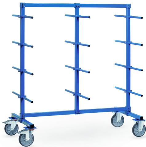
Rahmen aus stabilem Quadratrohr. Rollen-Traversen, Pfosten und Streben durch kräftige Schraubschellen verbunden. Tragarme aus Stahlrohr 27 mm Ø mit Schraubschellen. 24 Tragarme zweiseitig (12 Stück je Seite) Nutzlänge 370 mm. Pulverbeschichtet blau RAL 5007. Tragkraft pro Etage 120 kg (60 kg/Seite). 2 Lenk- und 2 Bockrollen, TPE-Bereifung, Nabens mit Rillenkugellager. Feststeller an den Lenkrollen.
