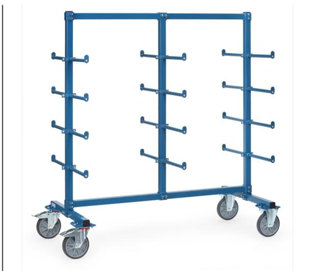
Rahmen aus stabilem Quadratrohr. Rollen-Traversen, Pfosten und Streben durch kräftige Schraubchellen verbunden. Tragarme aus Stahlrohr 27 mm Ø mit Schraubchellen. 24 Tragarme zweiseitig (12 Stück je Seite) Nutzlänge 370 mm mit Abrollsicherung als Anschlag an den Enden nutzbar. Pulverbeschichtet blau RAL 5007. Tragkraft pro Etage 120 kg (60 kg/Seite). 2 Lenk- und 2 Bockrollen, TPE-Bereifung, Naben mit Rillenkugellager. Feststeller an den Lenkrollen.
