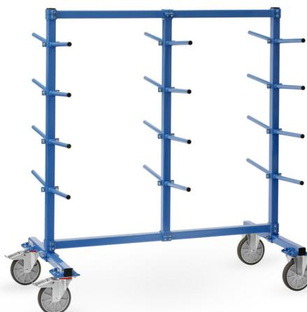
Rahmen aus stabilem Quadratrohr. Rollen-Traversen, Pfosten und Streben durch kräftige Schraubschellen verbunden. Tragarme aus Stahlrohr 27 mm Ø mit Schraubschellen. Zweiseitig 24 Tragarme 5° geneigt (12 Stück je Seite). Nutzlänge 370 mm, Tragkraft pro Etage 120 kg (60 kg/Seite). 2 Lenk- und 2 Bockrollen, TPE-Bereifung, Nabens mit Rillenkugellager. Feststeller an den Lenkrollen.
