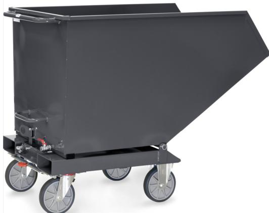
Muldenkipper mit kippbar gelagerter Mulde aus 2 mm starkem Stahlblech, Rand oben zweimal umgekantet, Schüttkante doppelt umgelegt, öldicht verschweißt. Untergestell aus 3 mm starken Kantprofilen mit integrierten Staplertaschen. Trittlech und Kippsicherung, Rohrschiebegriff. Pulverbeschichtung anthrazitgrau RAL 7016. 2 Lenk- und 2 Bockrollen. Räder mit TPE-Bereifung, Nabens mit Rillenkugellager.
