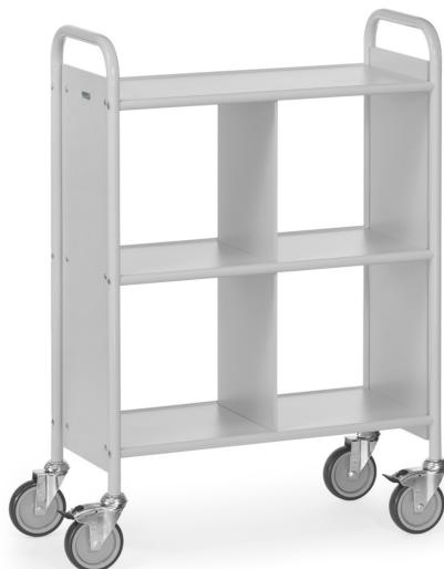
Baukasten-System: verschraubte Stahlrohr-Konstruktion, pulverbeschichtet in lichtgrau RAL 7035. Böden, Seitenwände und Trennwand aus Holzwerkstoffplatten, hellgrau. 4 Lenkrollen, Räder mit TPE-Bereifung, elastisch und leicht laufend, spurlos. Nabens mit Gleitlager. 2 Lenkrollen mit Feststeller. Zerlegte Anlieferung, leichte Selbstmontage.
