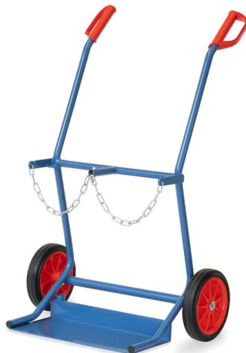
Stahlflaschenkarre aus Stahlrohr geschweißt, pulverbeschichtet blau RAL 5007. Flaschenhalterungen mit Kettensicherung. Räder mit Vollgummibereifung, Nabens mit Rollenlager.
