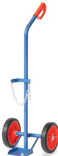
Stahlflaschenkarre aus Stahlrohr geschweißt, pulverbeschichtet blau RAL 5007. Flaschenhalterungen mit Kettensicherung. Räder mit Vollgummibereifung, Nabenhügel mit Rollenlager.
