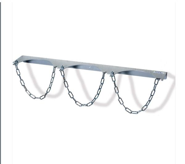
Stahlflaschen-Wandhalterung für 3 Stahlflaschen mit 140 mm Durchmesser. Stahlblechkonstruktion, feuerverzinkt. Mit Kettensicherung und Bohrungen zur Wandbefestigung.
