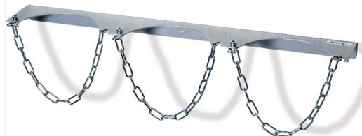
Stahlflaschen-Wandhalterung für 3 Stahlflaschen mit 230 mm Durchmesser. Stahlblechkonstruktion, feuerverzinkt. Mit Kettensicherung und Bohrungen zur Wandbefestigung.
