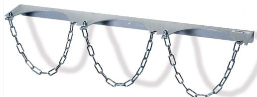
Stahlflaschen-Wandhalterung für 3 Stahlflaschen mit 320 mm Durchmesser. Stahlblechkonstruktion, feuerverzinkt. Mit Kettensicherung und Bohrungen zur Wandbefestigung.
