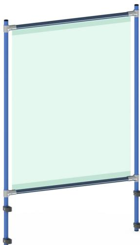
Infektionsschutzrahmen als Anbausatz für viele fetra-Transportgeräte. Rahmenkonstruktion Stahlrohr verschraubt, pulverbeschichtet blau RAL 5007. Transparente PVC-Folie als Barriere gegen Tröpfcheninfektionen, z.B. mit dem Coronavirus. Einfache Selbstmontage mittels Kunststoffschellen, auch nachrüstbar. Höhe justierbar, um z.B. eine Durchreiche zu erzeugen.
