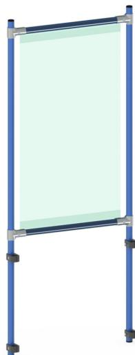
Infektionsschutzrahmen als Anbausatz für viele fetra-Transportgeräte. Rahmenkonstruktion Stahlrohr verschraubt, pulverbeschichtet blau RAL 5007. Transparente PVC-Folie als Barriere gegen Tröpfcheninfektionen, z.B. mit dem Coronavirus. Einfache Selbstmontage mittels Kunststoffschellen, auch nachrüstbar. Höhe justierbar, um z.B. eine Durchreiche zu erzeugen.
