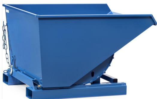
Selbstkipper müssen zum Entleeren nicht angehoben werden. Die leere Mulde geht selbsttätig in die Beladestellung zurück. Robuste Schweißkonstruktion aus 3-mm-Stahlblech, Lackierung blau RAL 5007. Serienmäßig mit Staplertaschen, Abrollsicherung und Kippverriegelung, Gliederkette als Abrutsch- und Kippsicherung. Zugseil zur Kippauslösung vom Staplersitz aus.
