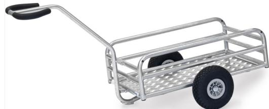
Handwagen für die Verwendung im Außenbereich. Aus Stahlrohr geschweißt, feuerverzinkt. Ladefläche aus Alu-Quintettblech. Geländer 180/250 mm hoch mit kräftigen Rohrverstrebungen. Anschraubbare Deichsel mit Sicherheitsgriff und hautsympathischem Softgrip-Bezug. Große Räder mit Luftbereifung, Nabens mit Rollenlager. Verschraubte Radbefestigung für einfachen Radwechsel.
