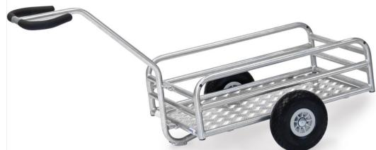
Handwagen für die Verwendung im Außenbereich. Aus Stahlrohr geschweißt, feuerverzinkt. Ladefläche aus Alu-Quintettblech. Geländer 180/250 mm hoch mit kräftigen Rohrverstrebungen. Anschraubbare Deichsel mit Sicherheitsgriff und hautsympathischem Softgrip-Bezug. Große Räder mit pannensicherer Polyurethanbereifung, Nabenhügel mit Rollenlager. Verschraubte Radbefestigung für einfachen Radwechsel.
