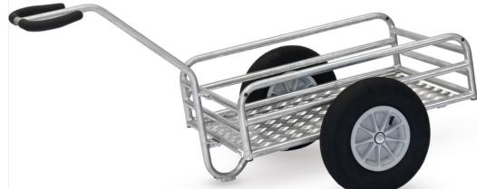
Handwagen für die Verwendung im Außenbereich. Aus Stahlrohr geschweißt, feuerverzinkt. Ladefläche aus Alu-Quintettblech. Geländer 180/250 mm hoch mit kräftigen Rohrverstrebungen. Anschraubbare Deichsel mit Sicherheitsgriff und hautsympathischem Softgrip-Bezug. Große Räder mit Luftbereifung, Nabenhügel mit Rollenlager. Verschraubte Radbefestigung für einfachen Radwechsel.
