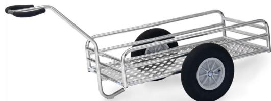
Handwagen für die Verwendung im Außenbereich. Aus Stahlrohr geschweißt, feuerverzinkt. Ladefläche aus Alu-Quintettblech. Geländer 180/250 mm hoch mit kräftigen Rohrverstrebungen. Anschraubbare Deichsel mit Sicherheitsgriff und hautsympathischem Softgrip-Bezug. Große Räder mit Luftbereifung, Nabenhügel mit Rollenlager. Verschraubte Radbefestigung für einfachen Radwechsel.
