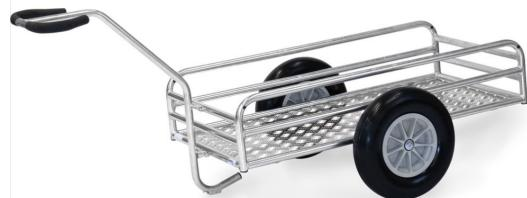
Handwagen für die Verwendung im Außenbereich. Aus Stahlrohr geschweißt, feuerverzinkt. Ladefläche aus Alu-Quintettblech. Geländer 180/250 mm hoch mit kräftigen Rohrverstrebungen. Anschraubbare Deichsel mit Sicherheitsgriff und hautsympathischem Softgrip-Bezug. Große Räder mit pannensicherer Polyurethanbereifung, Nabensicherung. Verschraubte Radbefestigung für einfachen Radwechsel.
