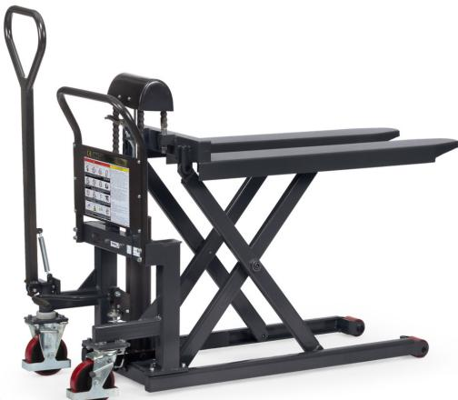
Gute Standfestigkeit, auch bei angehobener Last verfahrbar. Rahmen und Gabeln in stabiler verwindungsfreier Profilstahl-Konstruktion, pulverbeschichtet anthrazit grau RAL 7016. Kräftiger Rohr-Schiebebügel. Hydraulikpumpe mit verchromten Kolben und Überlastventil. Bedienung über Fußpedal. Senkventil über Handhebel zu betätigen. 2 Lenkketten mit Feststeller. Ausführung zusätzlich mit einer Lenkdeichsel ausgerüstet.
