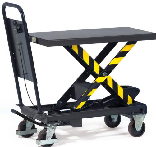
Profilstahl-/Stahlblech-Konstruktion, pulverbeschichtet anthrazitgrau RAL 7016. Kräftiger Rohrschiebebügel. Hydraulikpumpe mit verchromten Kolben. Betätigung über Fußpedal. Senkventil über Handhebel feinfühlig zu betätigen. Plattform 50 mm hoch. 2 Lenk- und 2 Bockrollen, Räder Polyurethan-Bereifung, Lenkrollen mit Feststeller. 2 Jahre Garantie
